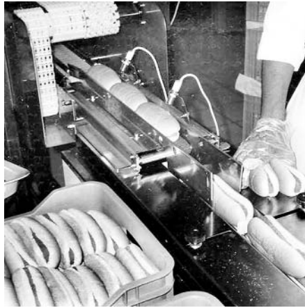
Технологический конвейер комплектации и упаковки хот-догов
