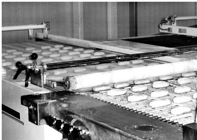
Прямой конвейер подачи хлебобулочных изделий
