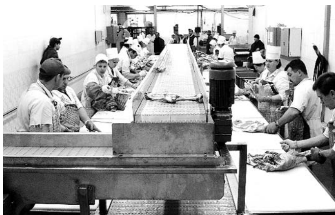
Технологические конвейеры обработки мяса (слева) и рыбы (справа)
