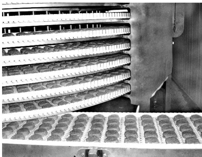
Спиральный конвейер шоковой заморозки продукции
