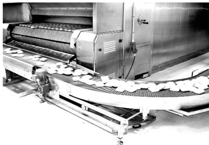
Поворотный конвейер подачи хлебобулочных изделий
