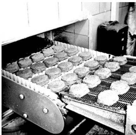
Конвейер подачи продукции (котлет)
