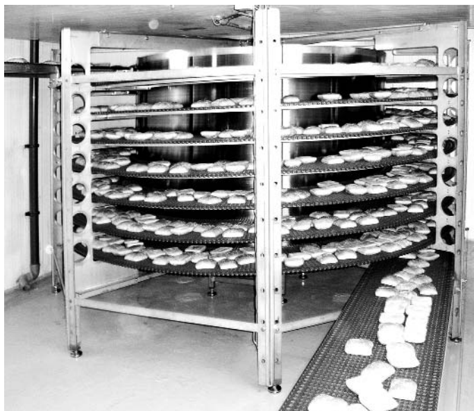
Спиральный конвейер охлаждения продукции
